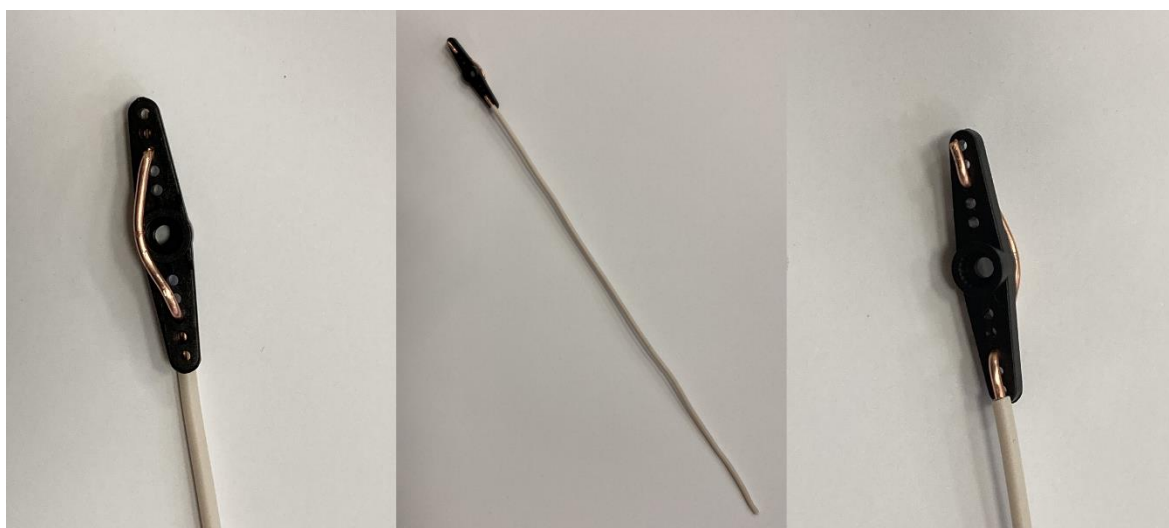
Рисунок 1. Пример крепления проволоки на качалку серводвигателя для изготовления организаторами.
